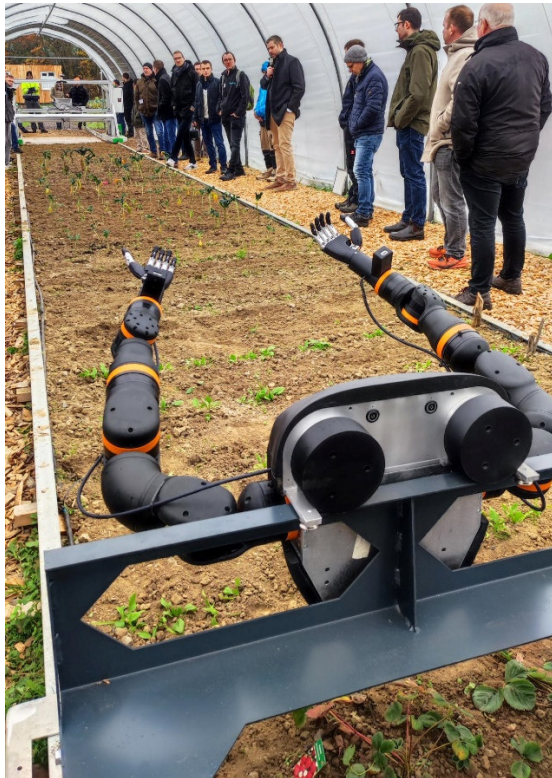
Der vollautonome „DAVEGI“ im Demonstrationsbeet: Das System erkennt Pflanzen, pflegt diese und führt präzise Arbeitsschritte aus.
